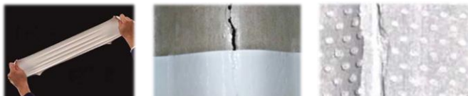
※波形スレートの割れに塗膜が追随しひび割れの表面化を防ぐ
